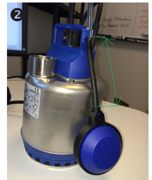
Vippans styrkabel skall vara 80 mm lång från pump till underkant flottör.
