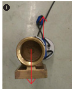
Pump och glidfäste ovanifrån. Notera att vippans riktning är 180 grader från utloppet på glidfästet.
