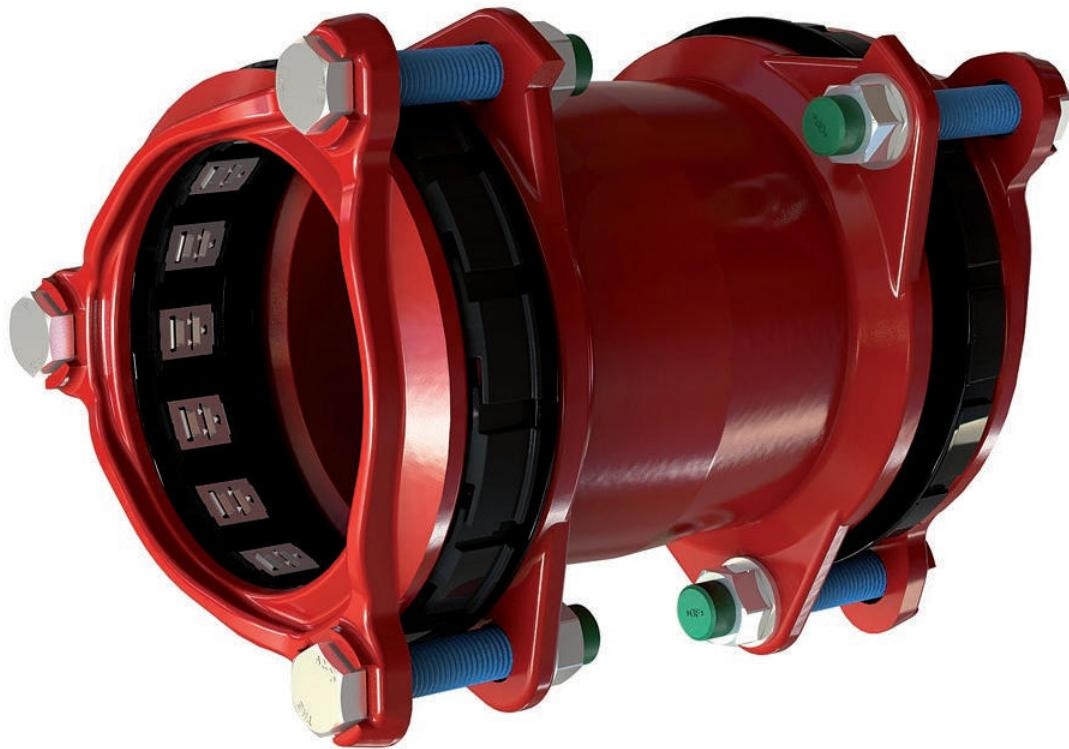
För alla typer av tryckrör som anges enligt punkt 4 och monteras helt enligt denna instruktion garanterar vi att Ulefos Multifix rörkopplingar, DN 50-600 är dragfasta upp t.o.m. tryckklass PN16 DN50-300 och PN10 DN350-600. Max tryckprovning 1,5 x PN.
