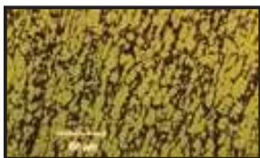
CW617N (MS58) Mörkt område = \beta -korn Kornstorlek = 20 \mu Förstoring 250 ggr
