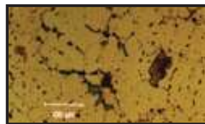
Gjutlegeringar Blåaktiga partiklar = bly Kornstorlek = 300 \mu Förstoring 250 ggr
